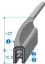
Réf. 1.757.000 1 – cellulaire = E.P.D.M. NOIR 2 – caoutchouc compact E.P.D.M. NOIR 3 – armature métal A = 0,8 à 1,5 rouleau de 30 m
